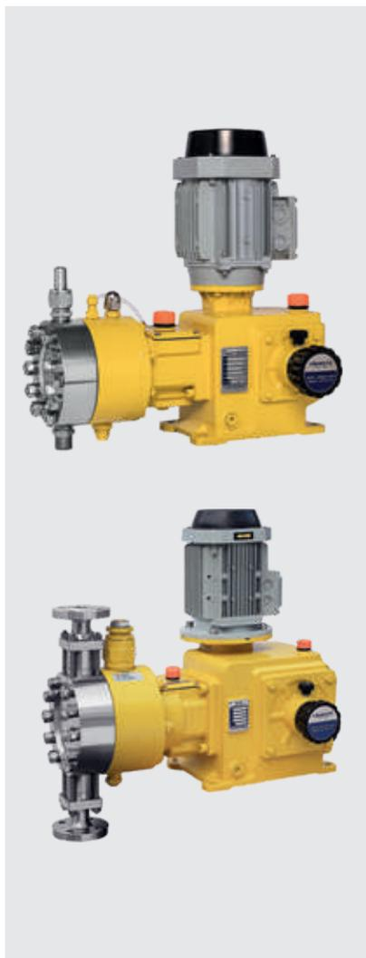
Возвратно-поступательное движение поршня внутри гидромеханической части, заполненной маслом, оказывает воздействие на мембрану, при помощи масла. Мембрана создает разрежение при всасывании жидкости и избыточное давление при ее нагнетании
